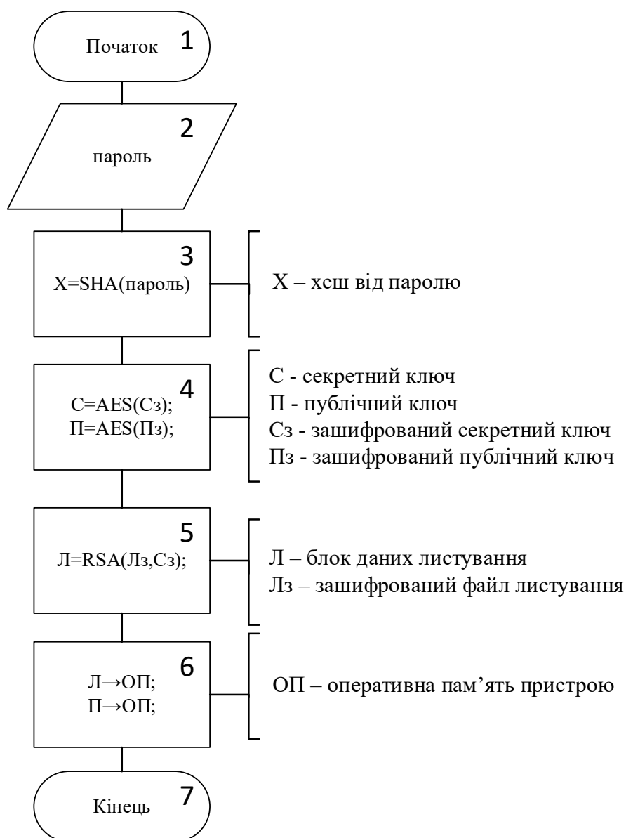
Рисунок 4.1 – Блок-схема алгоритму автентифікації та дешифрації листування.
