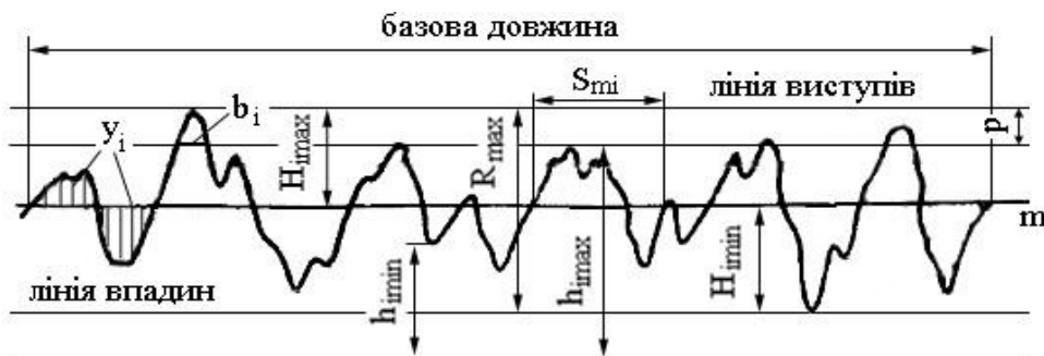
Рис. 2.4. Профіль шорсткості поверхні та його характеристики
