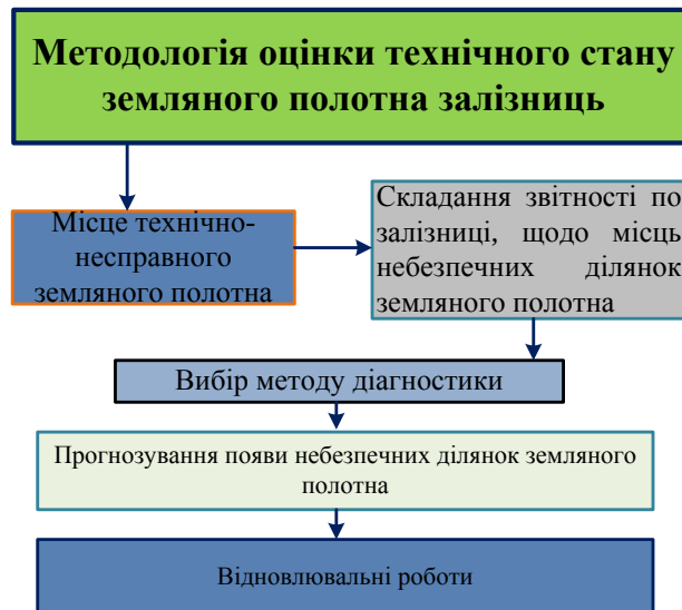
Рис. 2. Методологія діагностики технічного стану земляного полотна залізниць
