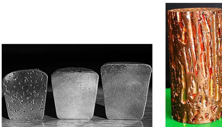
Рис. 1. Пористі виливки різних металів та злиток газара
