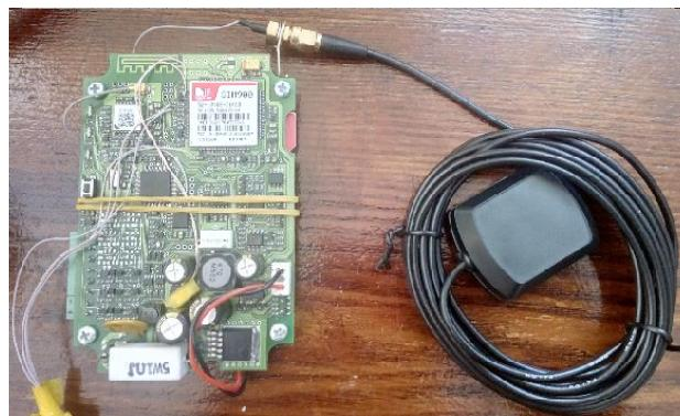
Рисунок 1.10 – Схема ділянки досліджень (а) та радіомодуль перетворення та передачі даних контрольно-вимірювального пункту (б)
