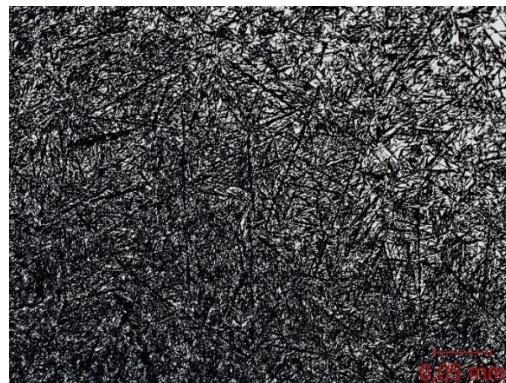
Рис. 1. Мікроструктура дифузійного шару сталі після режиму ХТО (варіант 2, табл. 3): a – збільшення \times 100 ; б – збільшення \times 200
