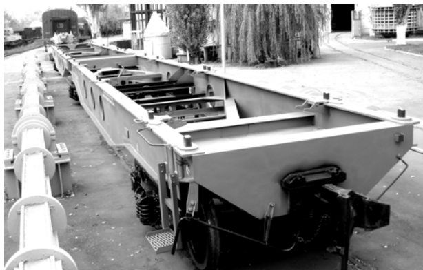
Рис.2. Вагон-платформа модели 13-1839 в испытательном стенде
