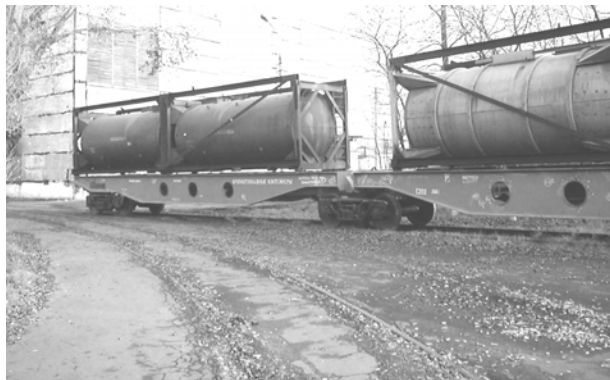
Рис. 4. Вагон-платформа модель 13-1839 при прохождении кривых малого радиуса
