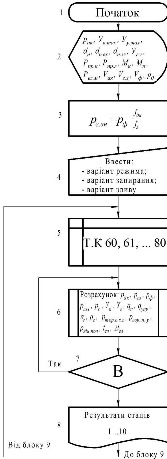
Рисунок – 3.2 Основна структурна схема алгоритму розрахунку процесу впорскування акумуляторної паливної системні з форсунками, що мають комбіноване замикання голки (початок)
