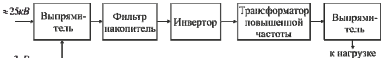
Рис. 1 Общая функциональная схема тягового преобразователя с промежуточным звеном повышенной частоты
