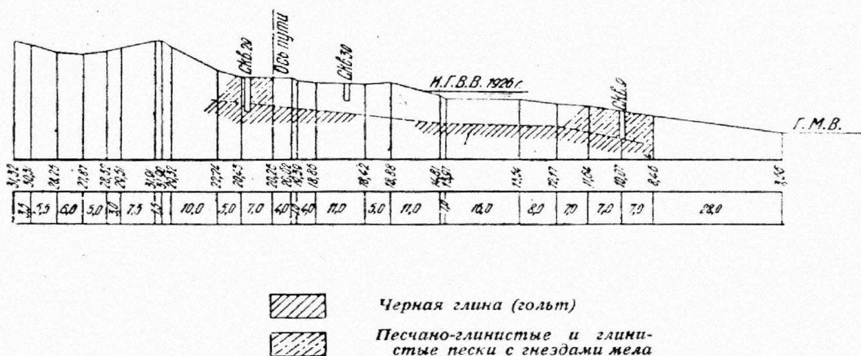
Фиг. 23. Поперечный геологический разрез; км 12+962 в пределах ст. Вольск.
