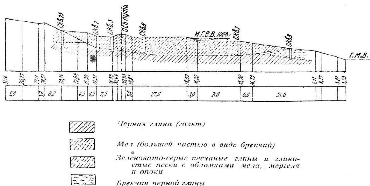
Фиг. 26. Поперечный геологический разрез; км 12 + 900 в пределах ст. Вольск.
