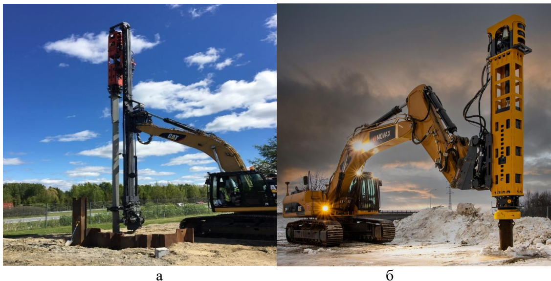
Рис. 1. Додаткове палезабивне обладнання для екскаваторів:
