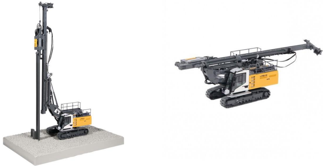
Рис. 2. Палезабивна та бурильна установка
