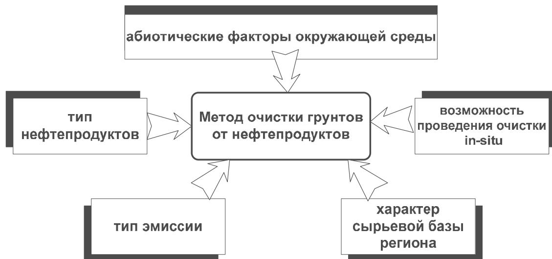
Рис. 1. Основные критерии дифференциации для выбора метода очистки грунтов от нефтепродуктов
