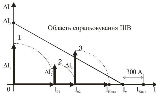
Рис. 3. Характеристики спрацювання при тяговому навантаженні
