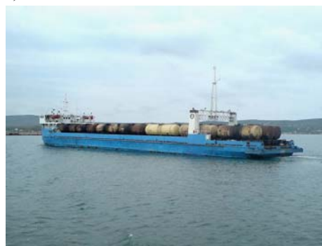
Рис. 1. Розміщення вагонів-цистерн на палубах залізнично-поромних суден під час руху морем: а) «Герои Одессы»; б) «Петровск»
