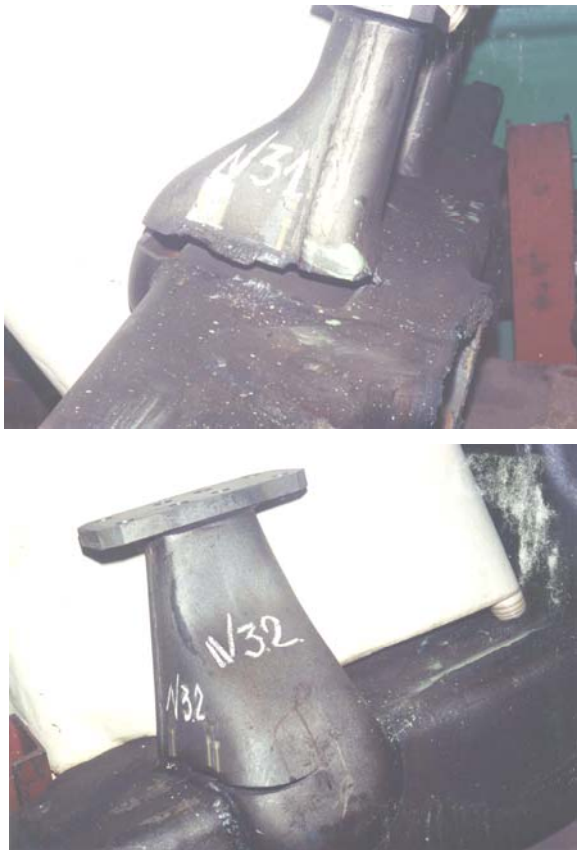
Рис. 4. Типове пошкодження кронштейнів буксових повідків
