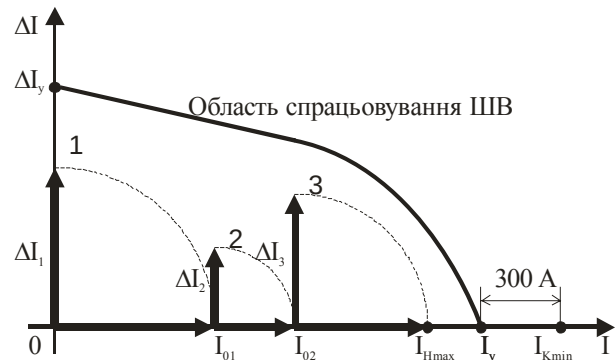
Рис. 4. Оптимальна характеристика спрацювання при тяговому навантаженні
