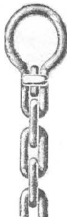
Фиг. 19. Приспособление для образования петель из цепи.
