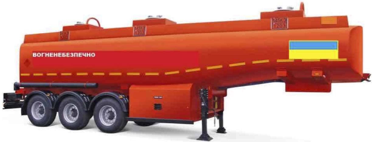
Рис. 2.4 Загальний вигляд автоцистерн ППЦ – 969226-05 для транспортування нафтопродуктів
