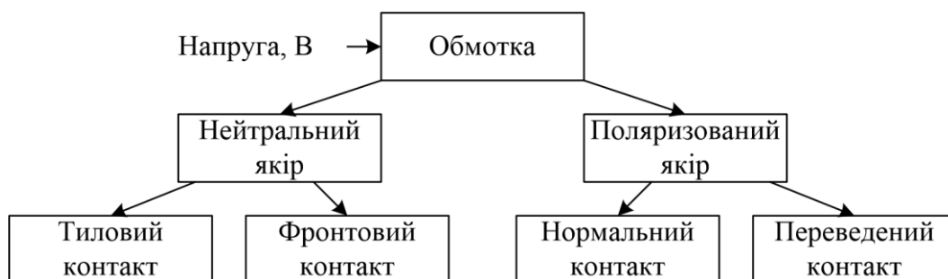
Рис. 4.1. Функційна схема електромагнітного комбінованого реле
