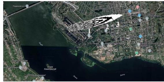
Рис. 4. Ізолінії концентрації азотної кислоти, рівень z = 25 м:
