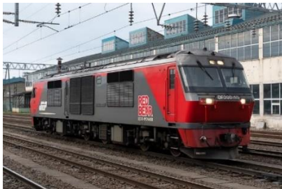
Рис. 2. Локомотиви з багатодизельними силовими енергетичними установками: a – локомотив ALP–45DP; b – локомотив EURO9000; в – тепловоз DF200; г – тепловоз Traxx DE ME
