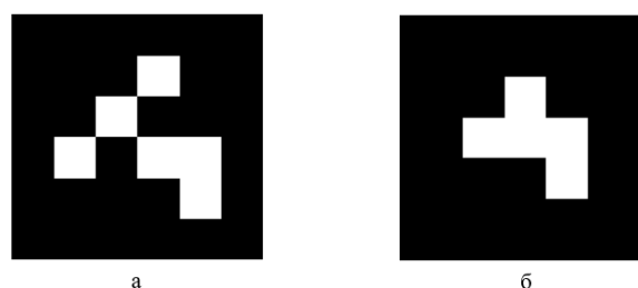
Рис. 4. Схожі між собою маркери у словниках різних систем: а – ArUco 4 x 4 з id=14; б – ARToolKitPlus 3 x 3 з id=17
