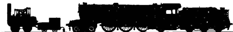
Фиг. 26а. Паровоз Стефенсона 1825 года и современный паровоз типа Пасифик постройки 1924 года, изображенные в одном масштабе.
