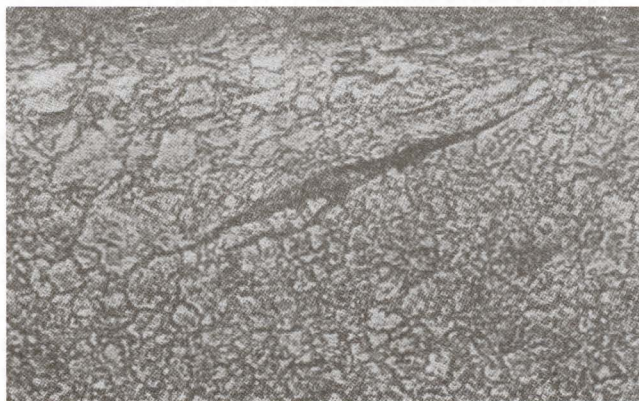
Рис. 2. Пластическое течение металла вблизи с поверхностью катания железнодорожного колеса (увеличено в 100 раз)
