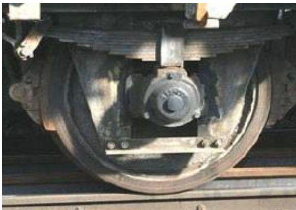
Рисунок 1.12 – Джерело шуму при прижимі колодки до колеса рухомого складу
