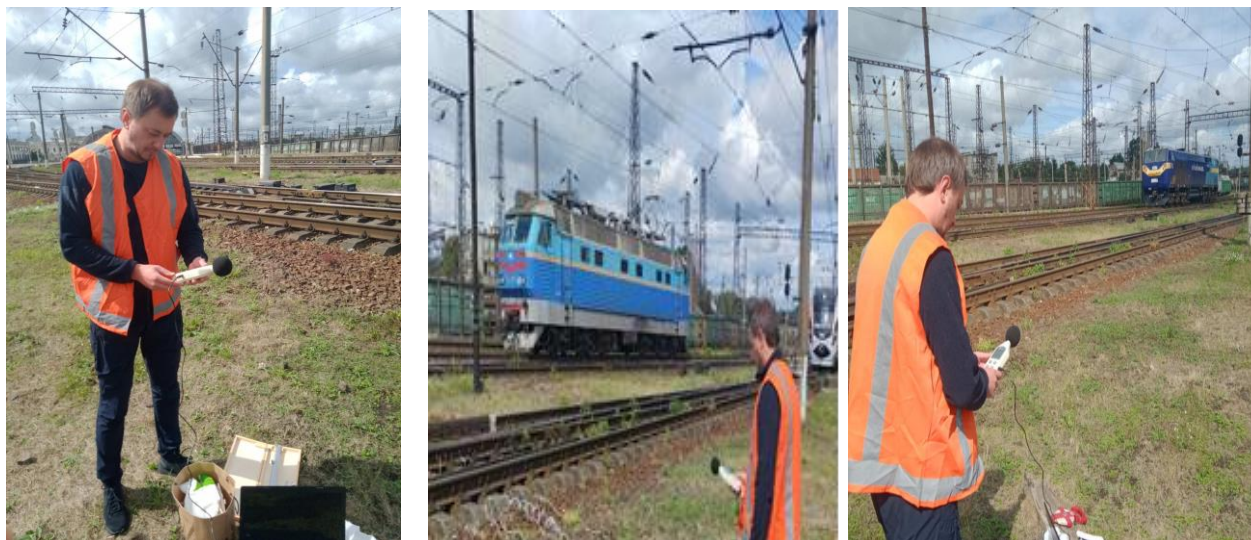
Рисунок 3.4 – Експериментальні вимірювання шумового навантаження при проїзді рухомого складу залізниць
