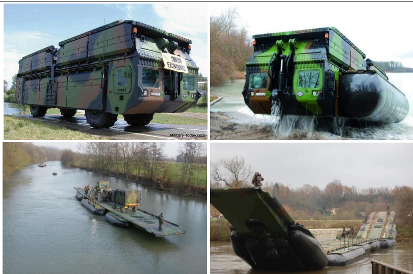
Рисунок 2 – Поромно-мостова машина ЕФА/ЕФА
