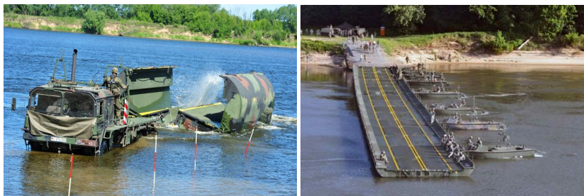
Рисунок 3 – Модернізований понтонний міст IRB (Improved Ribbon Bridge)
