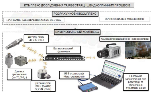
Рис. 8. Комплекс для дослідження та реєстрації швидкоплинних процесів
