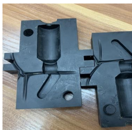
Рисунок 6 – Ливарна форма, яка отримана 3Д-друком.
