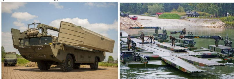
Рисунок 1 – Амфібійний міст та паромна система М3
