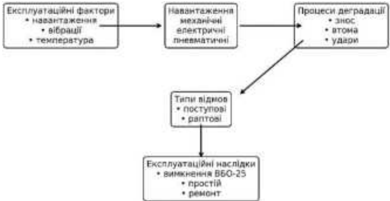
Рисунок 2.1 – Структурна схема формування експлуатаційних відмов головного вимикача ВБО-25
