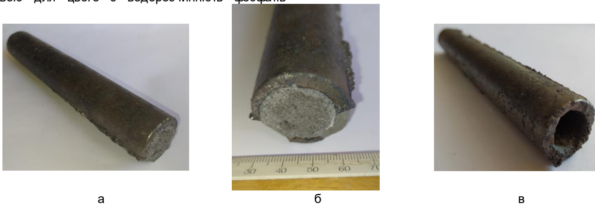
Рисунок 6 – Насадки пальників теплових агрегатів, сталь 30\text{X}25\text{Ю}2\text{ТЛ} , температура заливання 1580^\circ\text{C} : а – загальний вигляд виливка; б – виливок до вилучення стрижня; в – виливок після вилучення стрижня
