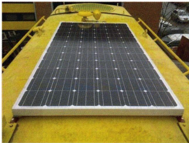
Рисунок 7 – Сонячна батарея, яка встановлена на капоті тепловоза Janine
