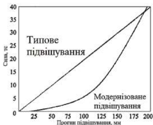
Рисунок 3.14 - Силова характеристика типового і модернізованого ресорного підвішування локомотива
