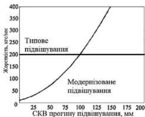
Рисунок 3.15 – Динамічна жорсткість модернізованого ресорного підвішування локомотива ВЛ82
