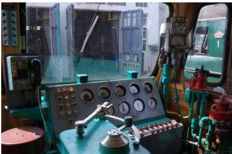
Рисунок 2.12 – Робоче місце машиніста електровоза ВЛ82 М
