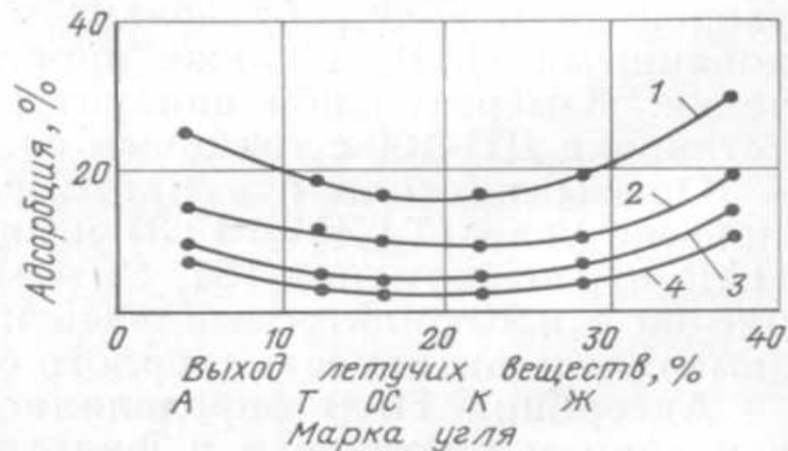
Рис. 5. Адсорбция ПАВ на углях разной степени метаморфизма (метод радиоактивных индикаторов): 1 — ДБ (0,1 %-ной концентрации); 2 — алкамон ДС; 3 — ДБ; 4 — НБ
