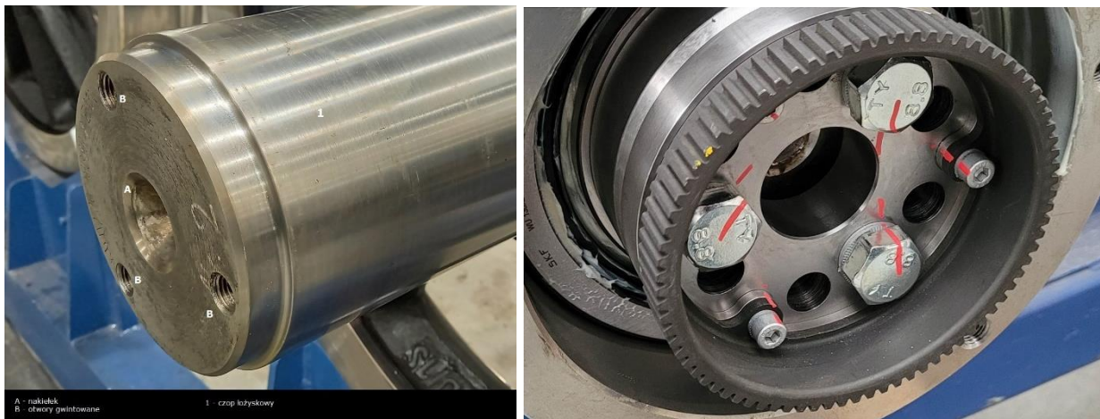
Рисунок 13 – Загальний вигляд торця шийки вісі під кріплення зубчастого колеса та системи противоюзного пристрою
