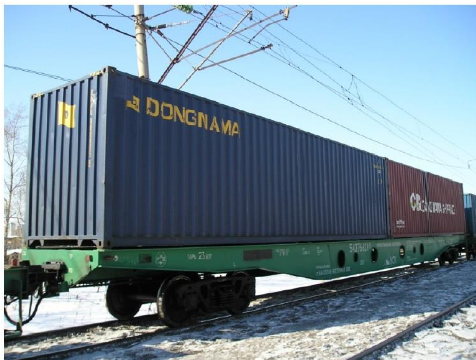
Рисунок 3.7 – Фитинговая длиннобазная вагон-платформа.
