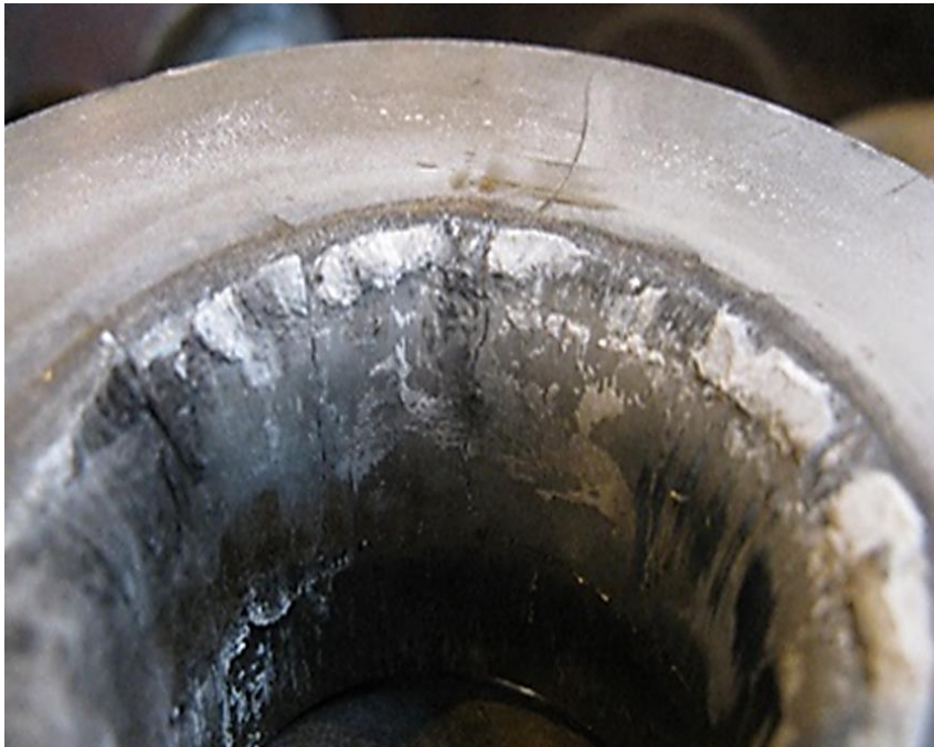
Рисунок 1. Фото зносу матриці трубопрофільного пресу
