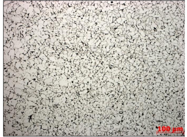
Мал. 7 – Структура зварного шва, зразок №3: а – ділянка перегріву, б – ділянка нормалізації
