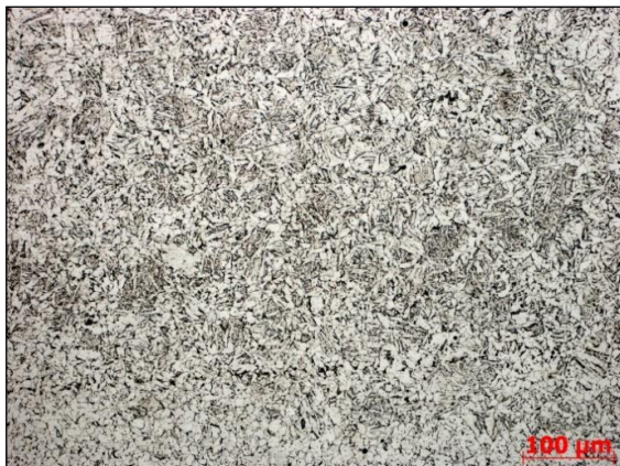
Мал. 5 – Структура зварного шва, зразок №2: а – ділянка перегріву, б – ділянка нормалізації
