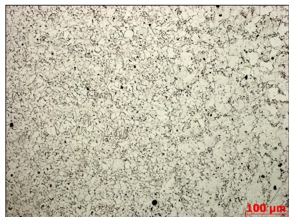
Мал. 3 – Структура зварного шва, зразок №1: а – ділянка перегріву, б – ділянка нормалізації
