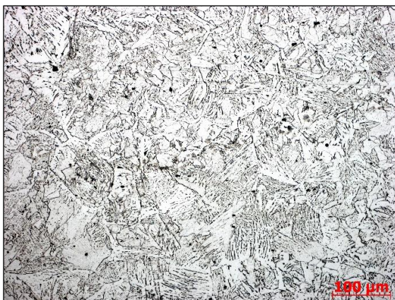
Мал. 3 – Структура зварного шва, зразок №1: а – ділянка перегріву, б – ділянка нормалізації
