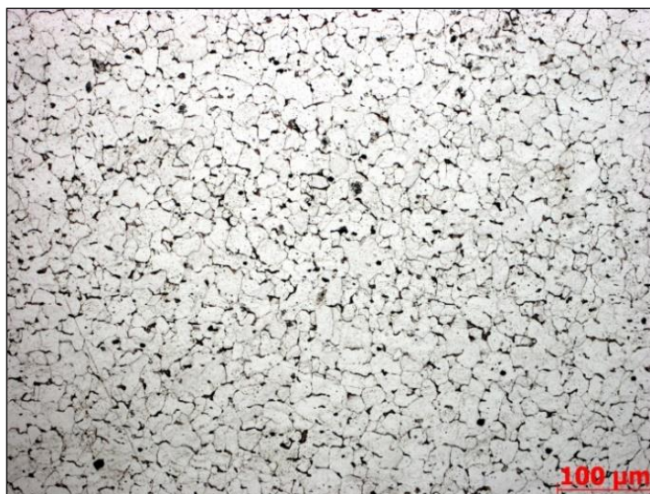
Мал. 1 – Структура гарячекатаної заготовки для виготовлення зварних труб, сталь марки ЗПС
