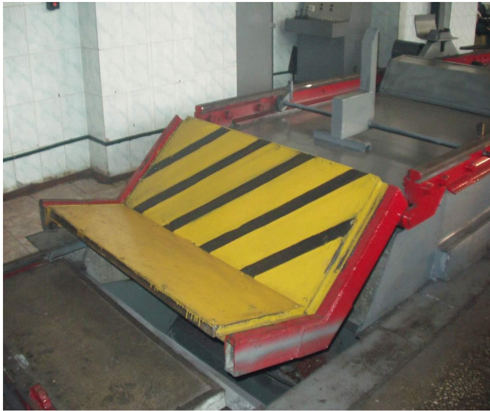
Рисунок 7 – Механізм підйому та опускання колісних пар
