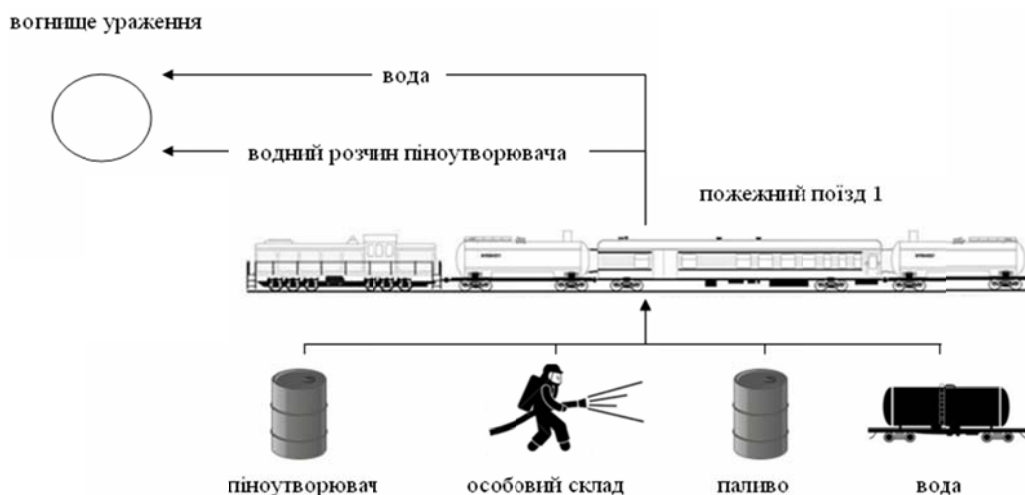
Рис. 3.6. Схема ліквідації надзвичайної ситуації одним пожежним поїздом з організованою доставкою засобів пожежогасіння та бойової обслуги
