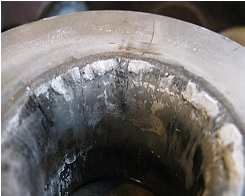
Рисунок 1. Фото зносу матриці трубопрофільного пресу
