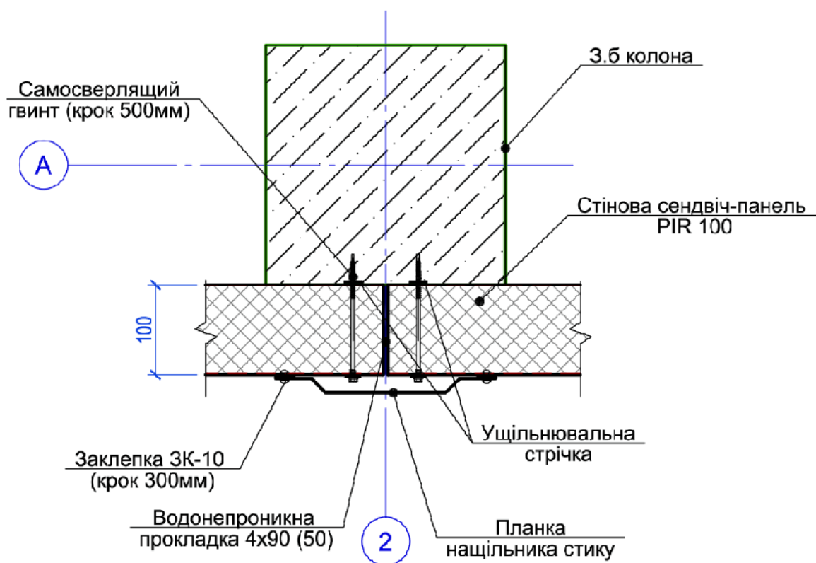
Рисунок 2.7 – Вузол кріплення сендвіч-панелі до ЗБ колони
