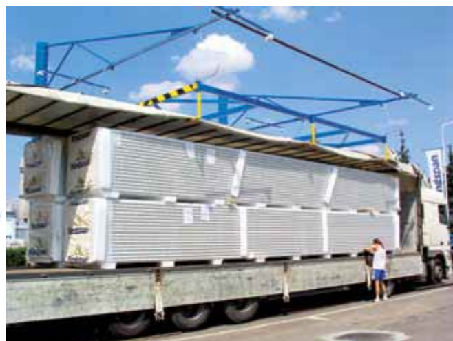
Рисунок 2.6 - Правильне завантаження панелей на транспортний засіб
