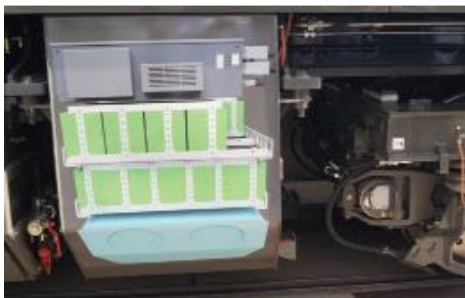
Рисунок 1.12 – Корпус батареї, виконаний у вигляді додаткового паливного бака
