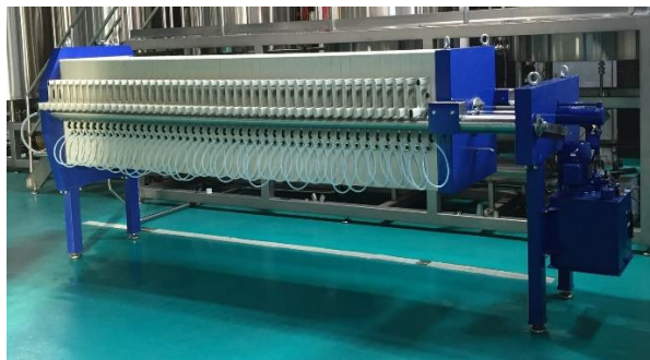
Рисунок 2.4 – Фільтр-прес (а) для зневоднення та бігуни (б) для розтирання порошку
