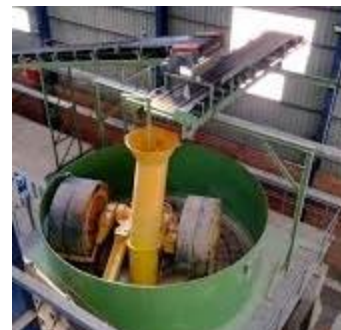
Рисунок 2.4 – Фільтр-прес (а) для зневоднення та бігуни (б) для розтирання порошку
