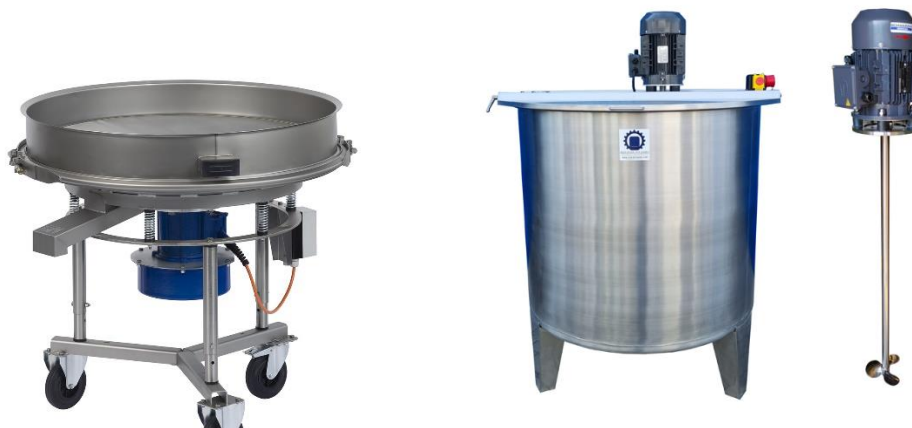
Рисунок 2.7 – Вібросито для видалення крупних часток (а) та пропелерний змішувач (б)
