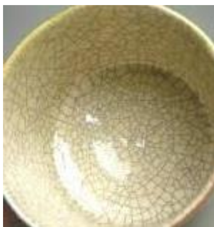
Рисунок 1.3 – Брак продукції типу «цек»
