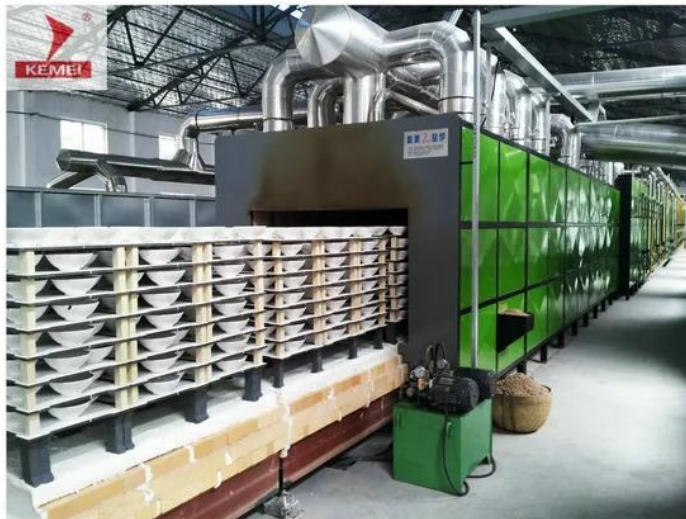
Рисунок 2.6 – Тунельна піч для випалу посуду
