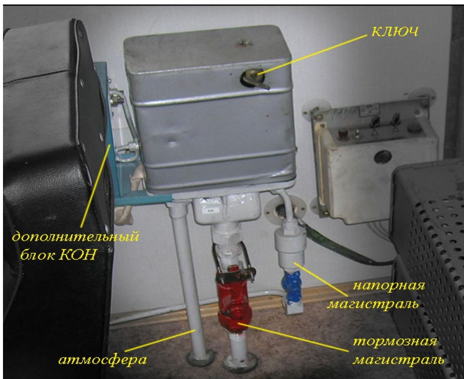
Рис 3.2 Клапан автостопа ЕПК-150
