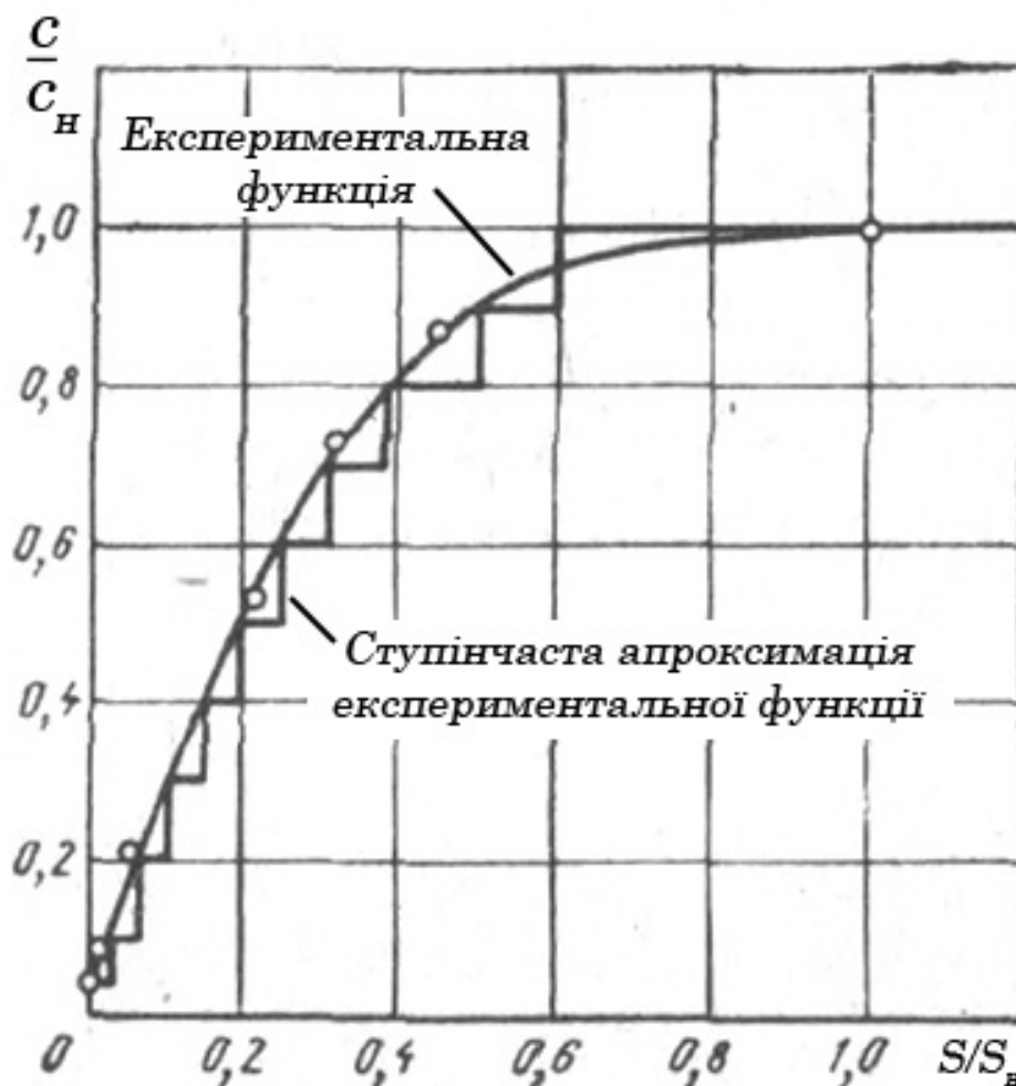
Рис. 3.1 Залежність відносної жорсткості вантажних канатів від відносного їх навантаження
