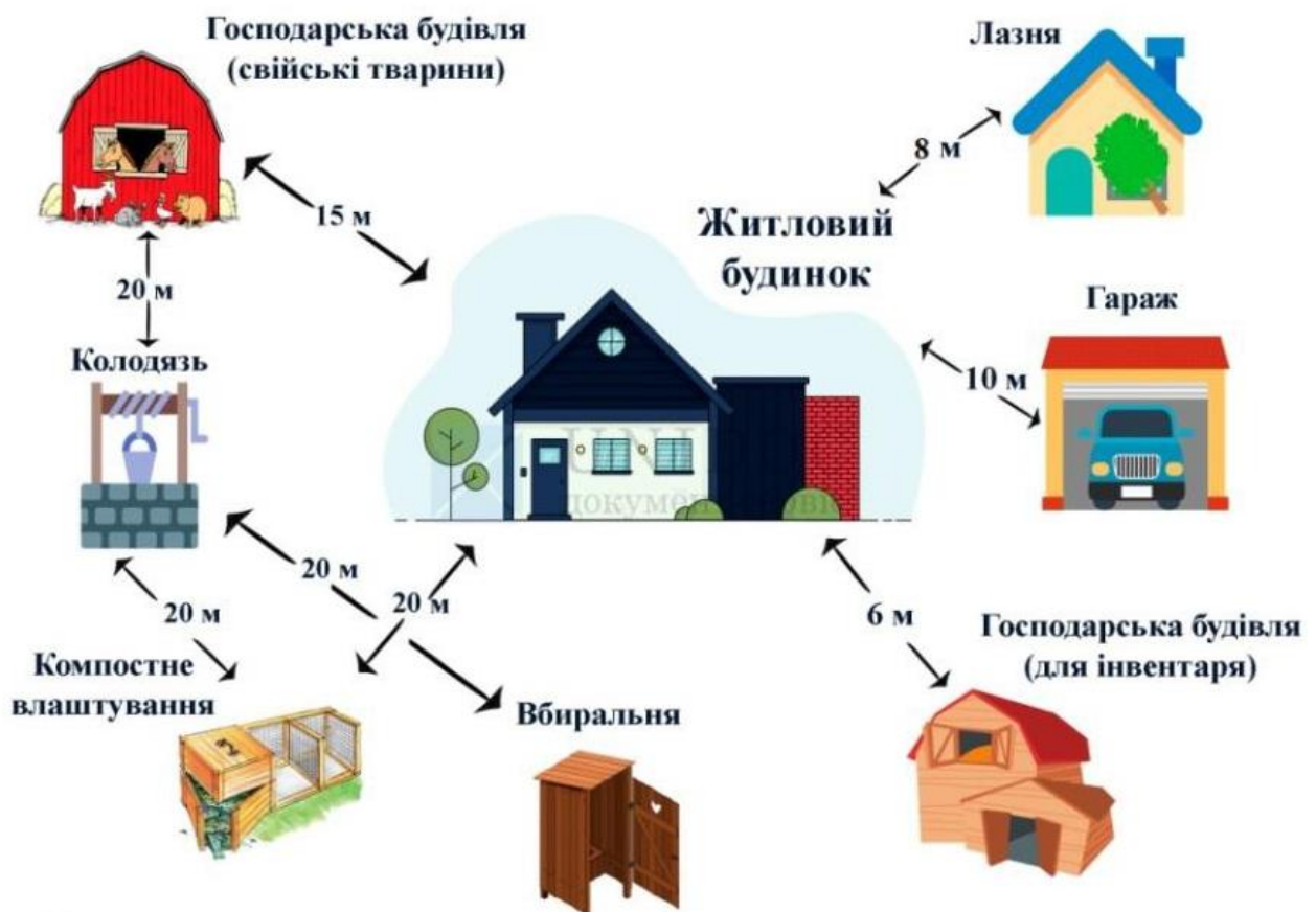
Рис. 5. Рекомендована схема розташування об'єктів будівництва в межах однієї ділянки
