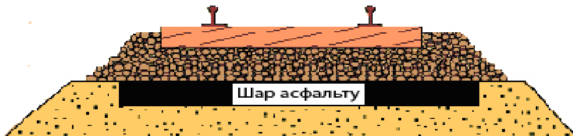
Рисунок 1.8 – Підсилення земляного полотна малодеформативним шаром асфальту
