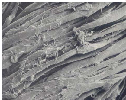
(в) Волокна білизни після 70 циклів прання в барабанних пральних машинах
