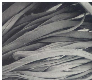
(б) Волокна білизни після 150 циклів прання в тунельній лінії
