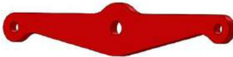
Рисунок 2.2 – 3D-модель балансира ГВП
