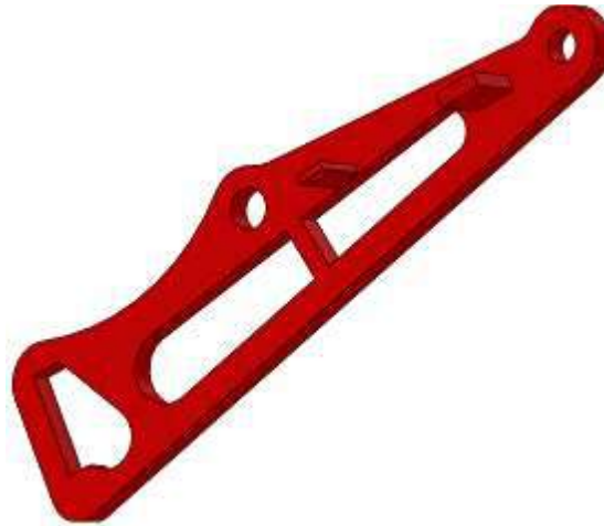
Рисунок 2.5 – 3D-модель підвіски ГВП
