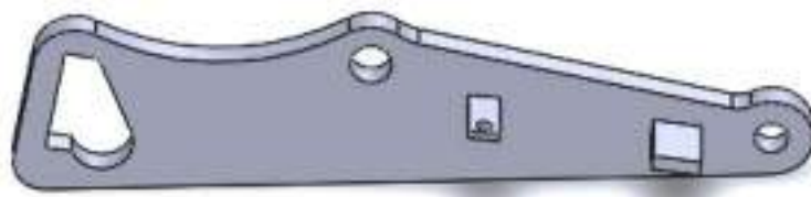
Рисунок 3.23 – 3D-модель підвіски ГВП
