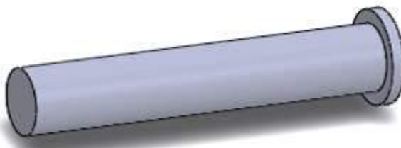
Рисунок 3.6 – 3D-модель втулки ГВП
