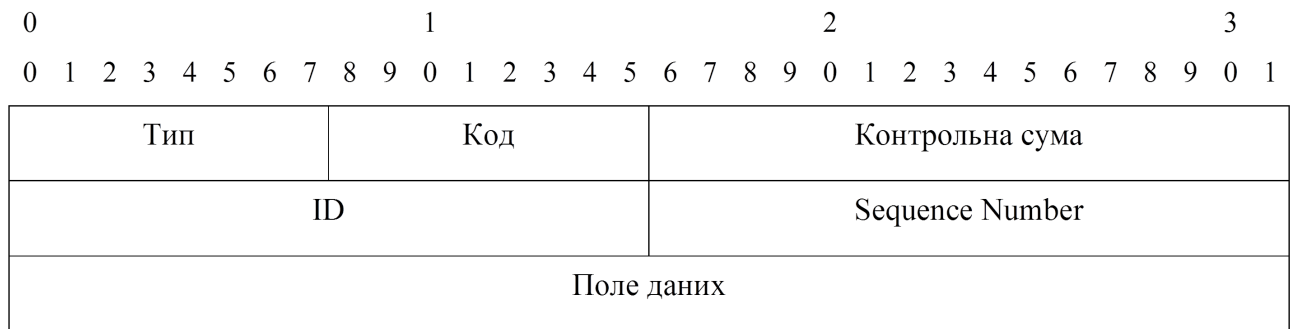
Рисунок 2.1 – Формат заголовку ICMP «Ехо-повідомлення та повідомлення у відповідь на ехо»
