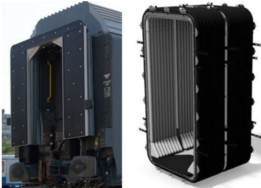
Рисунок 6 – Міжвагонний перехід фірми Hubner для вагонів поїздів міжнародних сполучень
