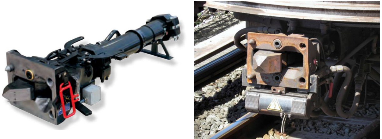
Рисунок 12 – Зчіпний пристрій Томлінсона
