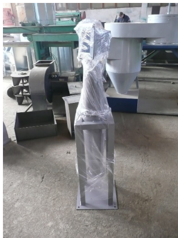
Рисунок 2.2 - Циклони серії ЦОК для очищення вентиляційних викидів від пилю
