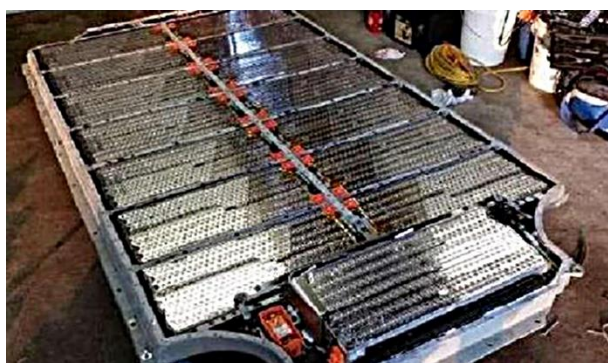
Рис. 4. Приклад елементів живлення 18650 та їхнього розподілу в акумуляторній батареї: a – приклад елементів живлення зразка 18650 (18 x 65 мм); б – акумуляторна батарея «Tesla Model S»
