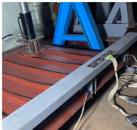
Рис. 7. Передача навантаження на фітинговий упор Fig. 7. Transferring the load to the fitting stop
