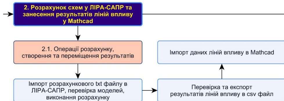
Рис. 8. Дії розрахунку схем ферм у ЛІРА–САПР та занесення результатів ліній впливу в Mathcad
