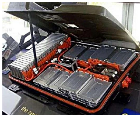
Рис. 3. Приклад пакетного полімерного елемента живлення та його розподілу в акумуляторній батареї «Nissan Leaf»:
