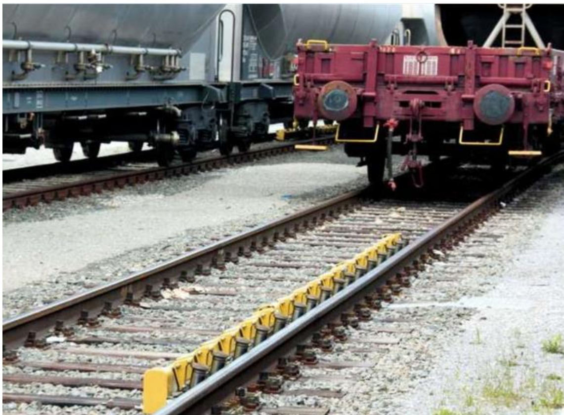
Рисунок 1.1 – Точечный вагонный замедлитель типа Trackguard Retarger ТКГ
