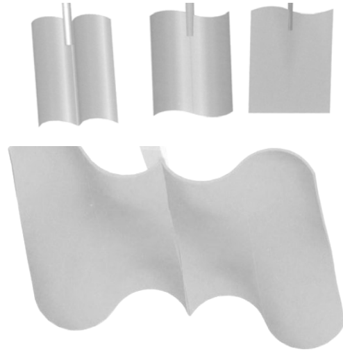
Рис. 7. Варианты лопастей переменного профиля
