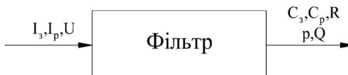
Рисунок 3.6 - Модель співвідношення виміряних і діагностуючих величин для системи низьковольтного живлення електровоза
