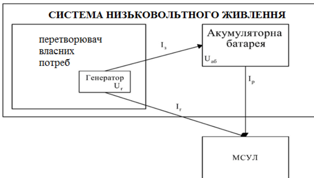
Рисунок 3.1 - Структурна схема організації системи низьковольтного живлення на сучасних і модернізованих електровозах
