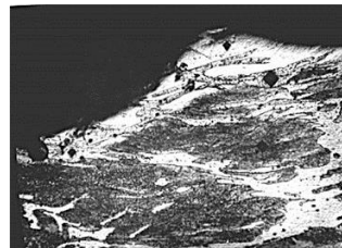
Рис. 4. Мікроструктура поверхневих шарів з відбитками алмазної піраміди, x 300
