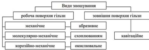
Рис. 3. Види зношування гільз циліндрів
