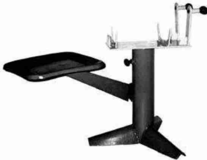
Рис. 1.1. Стенд для збирання та розбирання коробок зміни передач Р-201
