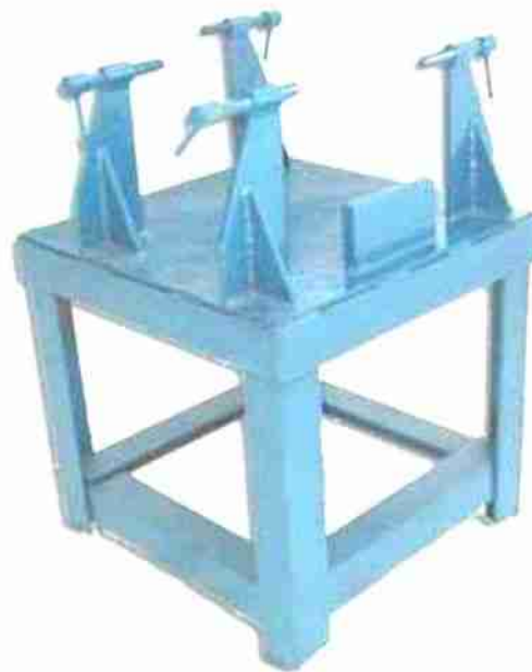
Рис. 1.2. Стенд ремонту коробок зміни передач СРК-120
