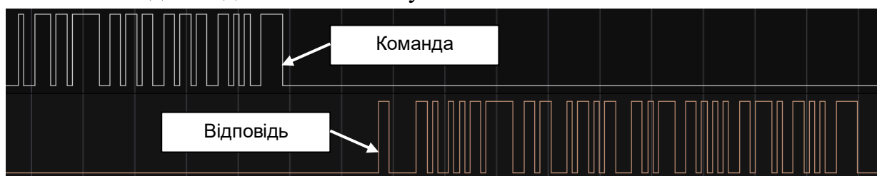
Рис. 4.12. Послідовні коди «команди» та «відповіді», отримані логічним аналізатором
